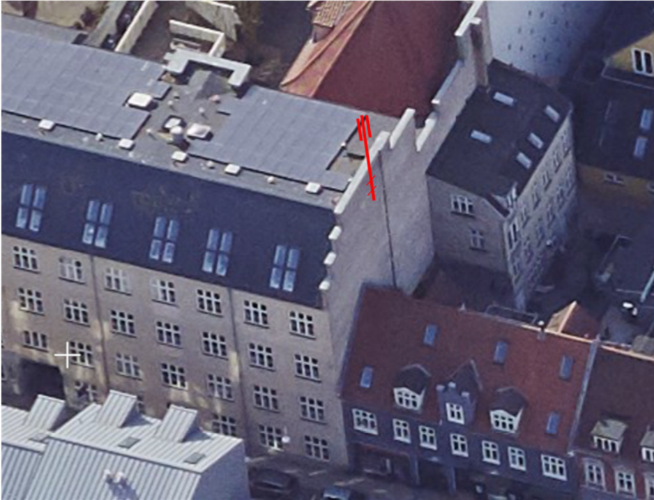
Figur 9 - Placering af bærerør med antennesystem på endegavl
